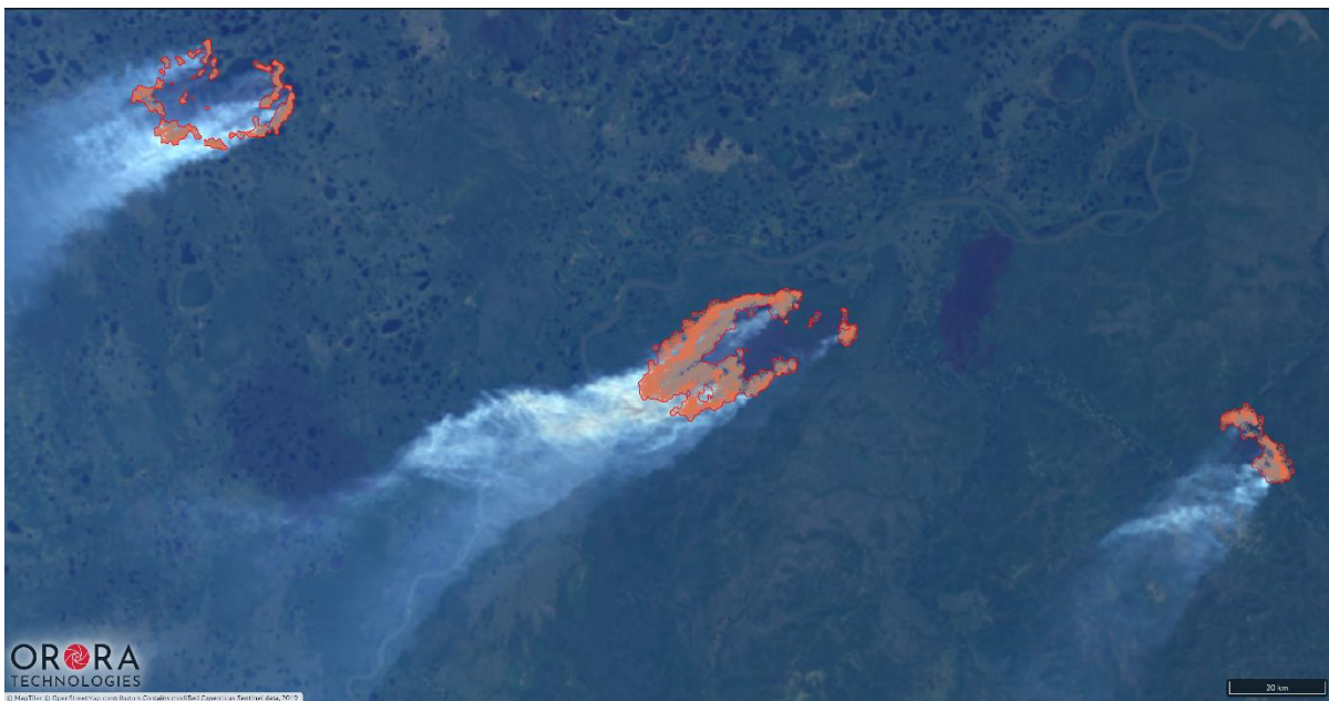
Abbildung 3: Thermal-Infrarot Detektion mit visuellem Overlay von massiven Bränden in Sibirien infolge einer Hitzewelle im nordöstlichen Russland, aufgenommen am 24.06.2020. Breite des Bildausschnitts ca. 300 km. Quelle: OroraTech
